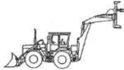
Esempio di terra con attrezzatura per la posa di pali
