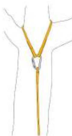
Fig. 4 - Possibile variante dello strozzo diretto della fune
