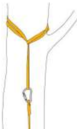
Fig. 5 - Ancoraggio della fune con dispositivo strozzo mediante anello di fettuccia
