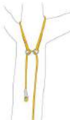
Fig. 8 - Ancoraggio passante per corda raddoppiata
