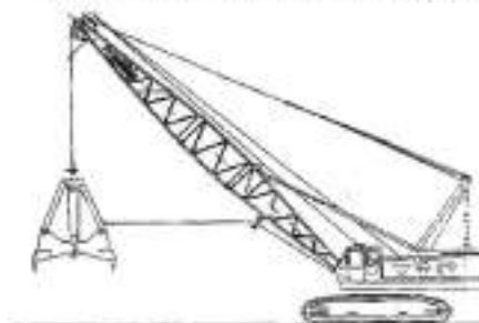
Esempio di escavatore a fune con benna fissa
