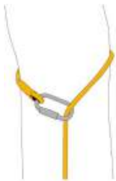
Fig. 2 - Strozzo diretto della fune
