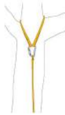
Fig. 5 - Ancoraggio della fune con dispositivo passante
